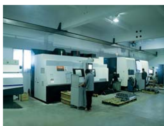
德国 / 日本进口双主轴车铣镗复合加工中心 Double-spindle turning & milling & boring machining center imported from Germany and Japan
